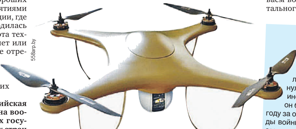
Беспилотный авиационный комплекс «Шершень» может проводить наблюдения как в видимом, так и в инфракрасном диапазонах.
